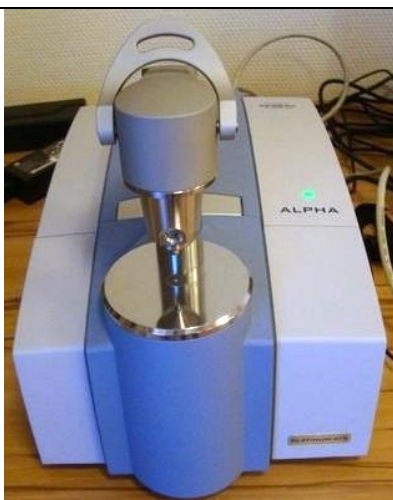
Fourier-Transformations- Infrarotspektrometrie Eine Diamantspitze fokussiert Infrarotlicht lasergenau auf unsere Partikel
